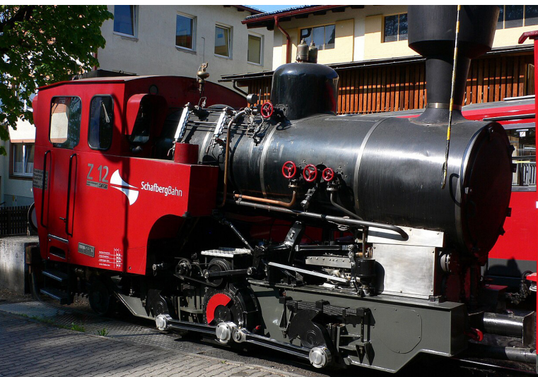
Die ölgefeuerten Neubau-Dampflokomotive Z 12
